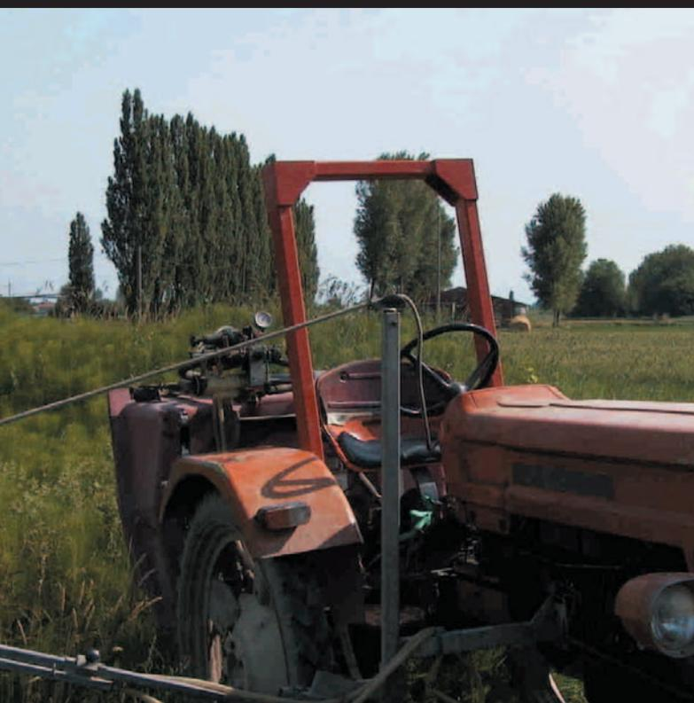
Controllare periodicamente che i fissaggi della protezione non siano allentati. Non apportare modifiche saldando parti o praticando fori, per non alterare la rigidità della struttura antiribaltamento.
