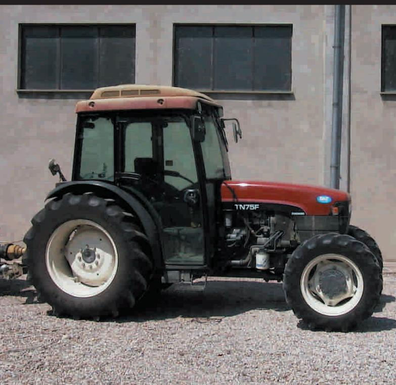
Tutte le trattrici agricole biassiali, a ruote, aventi una carreggiata minima superiore a 1 metro e di peso superiore agli 800 Kg. in ordine di marcia, devono essere dotate di cabina o di telaio con protezione antiribaltamento a quattro montanti.
